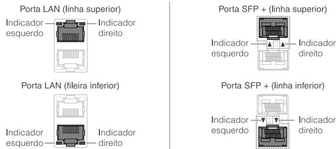
Existem diferentes modos de exibição, incluindo o modo "LINK / ACT" (no qual o status do link e a velocidade da conexão são exibidos), o "modo STATUS" (no qual o status de erro é exibido) e o "modo OFF" (no qual o indicador da porta está desligado).
