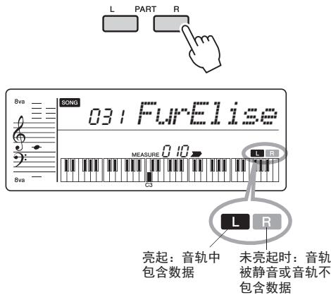
播放过程中打开或关闭左手和右手声部，可以试听某个声部（打开的），或在键盘上练习其它声部（关闭的）。
