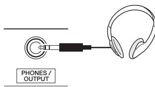
该处可以插入任何带有 1/4" 立体声插头的耳机，方便地进行监听。将插头插入此插孔后，扬声器将自动关闭。
