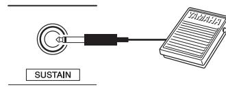
在演奏的同时踩下已插入[SUSTAIN]（延音）插孔的可选购踏板开关，可以产生自然的延音。
