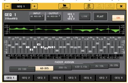
Na janela pop-up GEQ, use os botões no campo FADER ASSIGN para especificar a faixa de frequência que você deseja controlar. Ajuste o valor de ganho usando o atenuador atribuído para a faixa de frequência especificada. Pressione a tecla [ON] acesa para apagá-la, e o valor de ganho da faixa de frequência correspondência retornará imediatamente a  $\pm$  0 dB.
