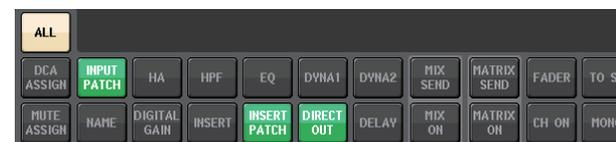
A figura indica que os parâmetros INPUT PATCH (patch de entrada), INSERT PATCH (patch de inserção) e DIRECT OUT (saída direta) foram definidos como Safe (seguro) pelas configurações de parâmetros globais de INPUT PATCH.
