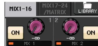
O botão giratório TO MIX SEND LEVEL é exibido com a mesma cor que o botão giratório correspondente da seção SELECTED CHANNEL. Nesse caso, você poderá usar o botão giratório correspondente da seção SELECTED CHANNEL para ajustar o nível do emissão.
