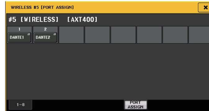
Exemplo: conectar a saída de um Shure AXT400 a OMNI 1 em um console CL e atribuir o sinal para ao canal de entrada 1.
