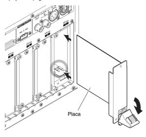
Empurre a placa no compartimento o máximo possível para que o conector na extremidade da placa seja inserido corretamente no conector interno do compartimento.
