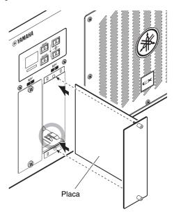
4. Prenda a placa usando os parafusos presos a ela.
