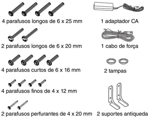
\* Os dois suportes antiqueda são idênticos. (qualquer um pode ser usado para a esquerda ou para a direita).
