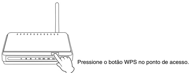
Quando a conexão à rede sem fio for concluída, a lâmpada de LED do UD-WL01 acenderá e, depois, piscará durante a comunicação por meio da rede. As informações necessárias serão definidas automaticamente, e a conexão entre o instrumento e o ponto de acesso terá sido concluída.
