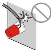
Se “Cheque-SP Fios” aparecer no visor frontal quando o aparelho está ligado, desligue o aparelho e verifique se há curto-circuito nos cabos dos alto-falantes.
