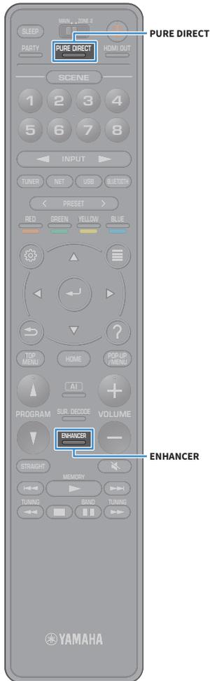
Quando Pure Direct for ligado, a unidade reproduz a fonte selecionada com o menor circuito para reduzir o ruído elétrico de outros circuitos (como o mostrador frontal). Isso permite que você desfrute de qualidade de som Hi-Fi.
