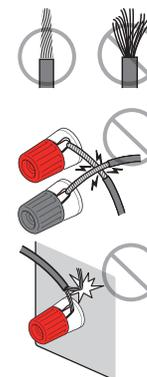
Se "Check SP Wires" aparecer no display frontal ao ligar a unidade, desligue a unidade e, em seguida, verifique se não há um curto-circuito dos cabos de alto-falante.
